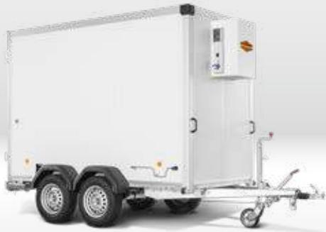
**Fourgons réfrigérés, roues extérieures, version un essieu ou deux essieux**
