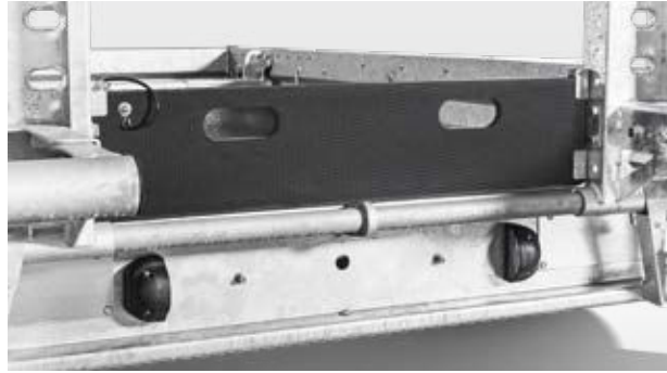
Panneau enfichable pour sécuriser la surface de chargement (seulement sur les modèles AS).
