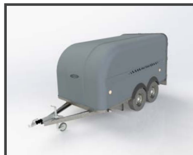
Carrosserie polyester monocoque aérodynamique.
